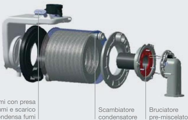
Collettore fumi con presa analisi fumi e scarico condensa fumi
